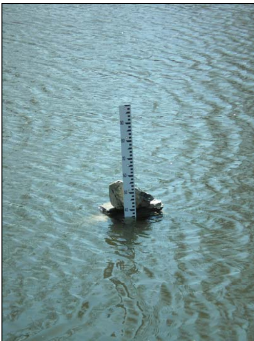
21. Detalle de la escala instalada en la Laguna de la Fuente Santa, indicando 36 cm de altura de lámina de agua el 29 de marzo de 2012.
